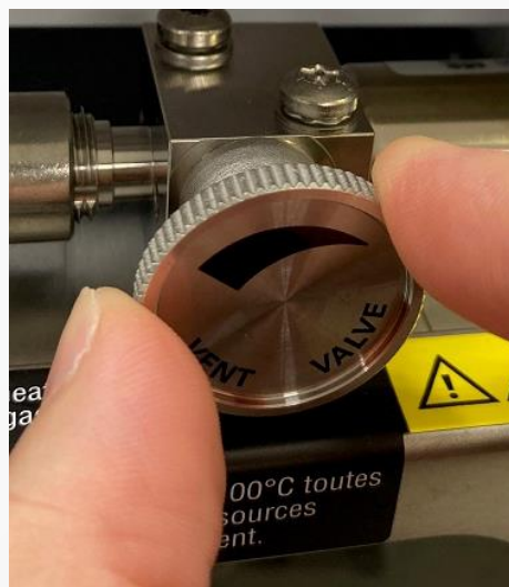
ベントバルブの閉め忘れ
