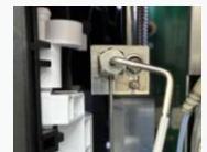
新しいニードルとサンプルループを取り付ける ニードル先端とシート穴の位置調整を行う
