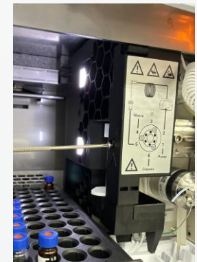
洗浄ポートを戻しカバーを取り付ける カウンターリセット！
